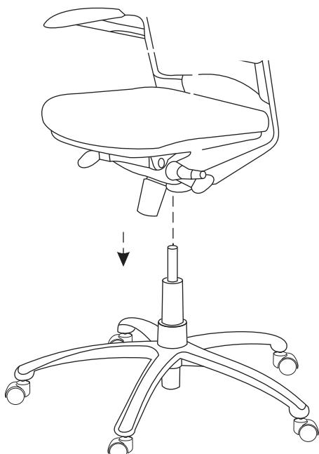
6. Поднимите готовый каркас кресла и оденьте его механизмом качания на шток газлифта. Необходимо некоторое усилие, для того чтобы газлифт вошел в отверстие (D) механизма качания.
